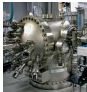
半導体ナノ構造センサー素子作製のための分子線結晶成長(MBE)装置
