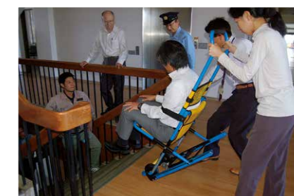
エレベーターが使用できない非常時などに、階段を使用して1人の補助で建物外へと避難させることができる階段避難車
