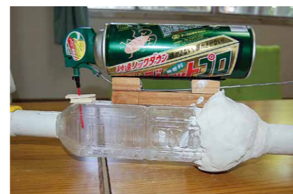
掃除機とペットボトルの接合部分を紙粘土で固定。ペットボトルの口部分は、何度も削り、調整を繰り返した結果、隙間なく接合した。マジックテープでスプレーを固定することにより、スプレーの取り替えも簡便となった。
